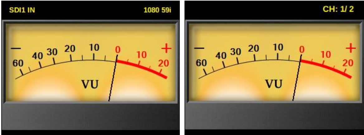
SDI1 入力(1080 59i)、ピークホールド無し、1/2ch モニタリング,針式 VU メーター(Wide)表示
