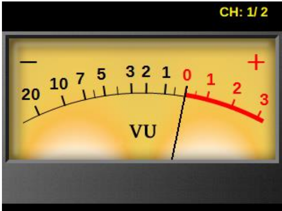
SDI1入力(1080 59i)、ピークホールド無し、1/2chモニタリング,針式VUメーター(Narrow)表示
