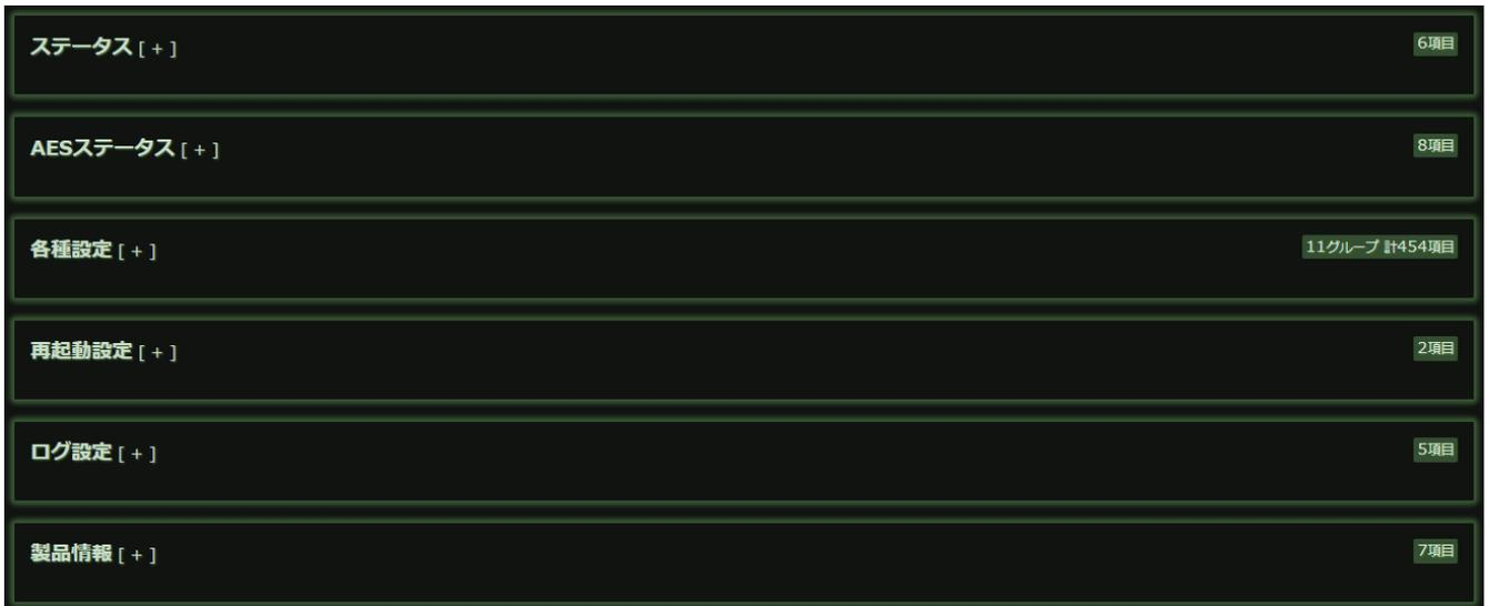
ステータス、AES ステータスには、モジュールの状態を、各種設定には、モジュールに設定できる項目を、製品情報には、モジュール名、プログラムバージョン等の製品情報を表示します。‘+’マークをクリックすることにより、各設定が表示されます。
