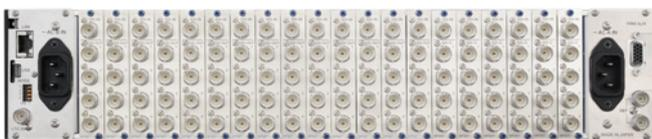
外形寸法 W482 × H88 × D400 質量 約 5.7 kg
