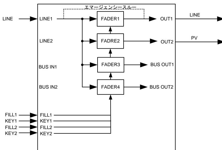
DSK2L に設定すると、下記のようにフェーダーが接続されます。本線 2 系統の DSK モードです。
