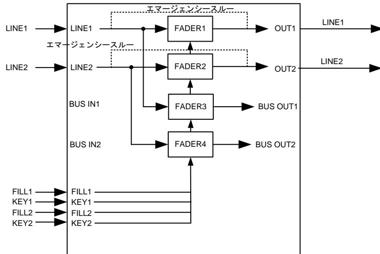
COMB に設定すると、下記のようにフェーダーが接続されます。2 系統のスーパーを合成し 1 系統の FILL/KEY を出力するコンバイナーモードです。
