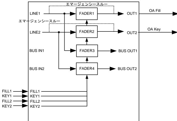
MANUAL に設定すると、各フェーダーへの入力信号の選択、スーパーの順序、各出力信号のどのフェーダーの出力を割り当てるかなどをマニュアル設定することができます。DSK1L 等で自動設定した後に、各種フェーダー設定等を変更すると、自動的に MANUAL モードとなります。通常は、DSK1L/DSK2L/COMB モードでお使いください。
