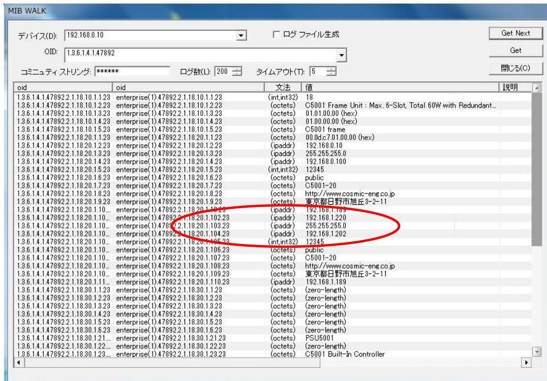
正しく設定されてない場合は、9-1-2 から再度実行してください。確認後、C5001 の電源をオフし、電源ランプが消えるまで待ち、十分電源が落ちたことを確認後、再度電源投入してください。新しい IP アドレスで起動します。
