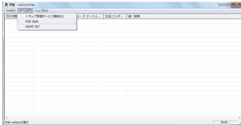
デバイスに現在の IP アドレス 192.168.0.10 を設定し、コスマックエンジニアリングの OID 1.3.6.1.4.1.47892 と設定し、Get Next ボタンを押します。
