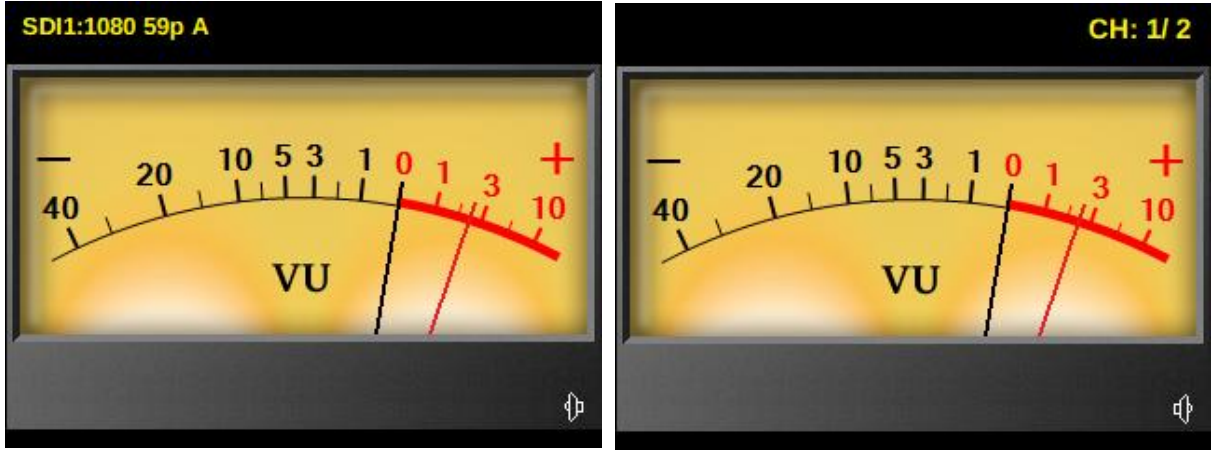
SDI1入力(1080 59pA)、ピークホールド1.5s、1/2chモニタリング,針式VUメーター(Normal)表示
