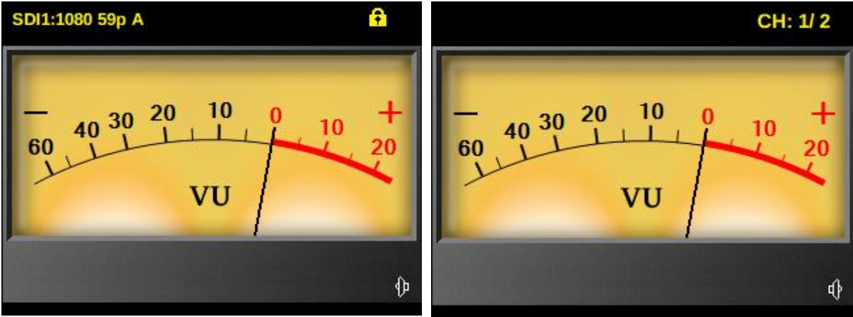
SDI1入力(1080 59pA)、ピークホールド無し、1/2chモニタリング,針式VUメーター(Wide)表示、キーロック状態
