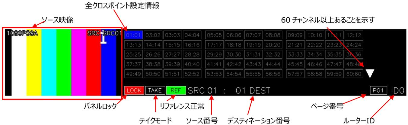
表示モード3では、全てのクロスポイント設定状態（SRC:DST）を表示します。ソース映像が表示されている領域には設定によりデスティネーション映像を出力することもできます。
