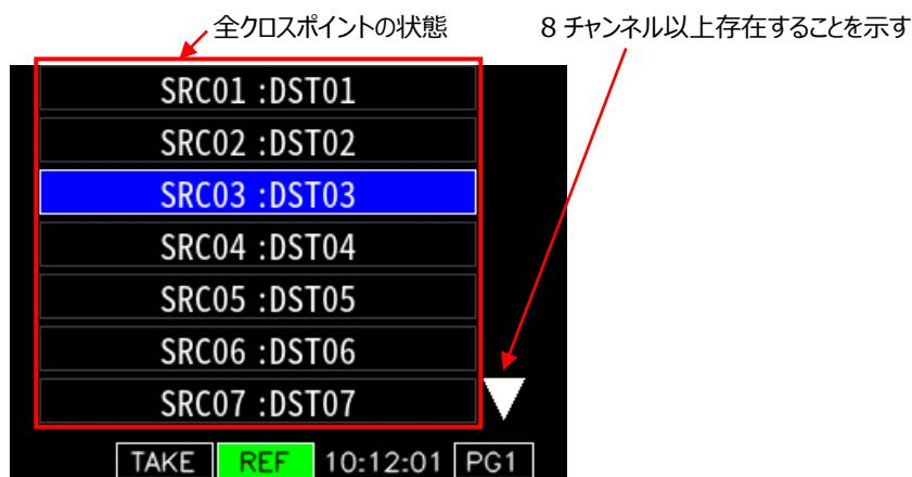
表示モード 2 では、全てのクロスポイントの状態が「ソースラベル : デスティネーションラベル」の形式で表示されます。現在選択されているデスティネーションが青表示となります。チャンネル数が多く 1 画面に収まらない場合は、画面の右端に三角または逆三角のマークが表示されます。
