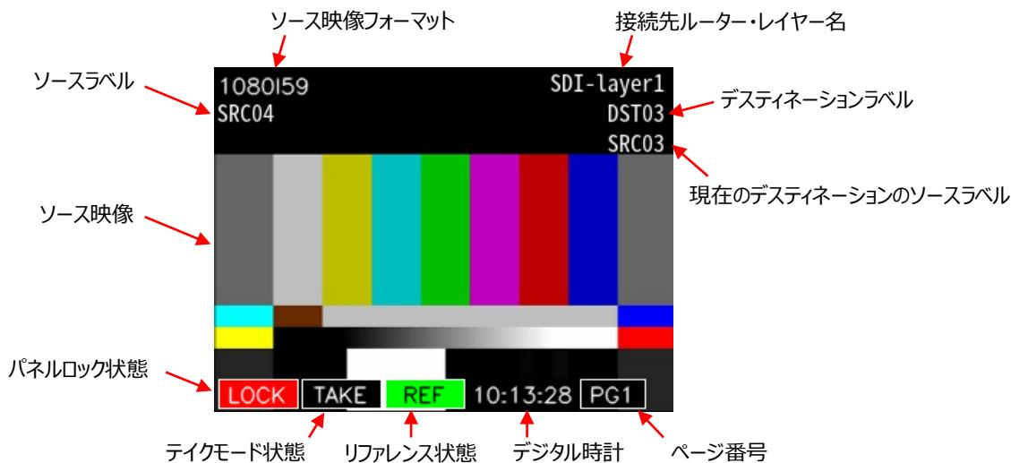
表示モード 1 は、上図に示した「ソースラベル」、「ソース映像」、「ソース映像フォーマット」、「デスティネーションラベル」、「現在のデスティネーションのソースラベル」、「接続先ルーター・レイヤー名」が表示されるモードです。「パネルロック状態」、「テイクモード状態」、「リファレンス状態」、「時計」、「ページ番号」は表示モード 2～5 でも表示されますが、ここでまとめて説明します。
