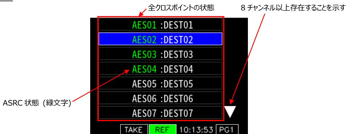
表示モード 2 では、全てのクロスポイントの状態が「ソースラベル : デスティネーションラベル」の形式で表示されます。現在選択されているデスティネーションが青表示となります。ソースラベルが緑色で表示されている場合は、そのソースに ASRC が割り当てられていることを示します。チャンネル数が多く 1 画面に収まらない場合は、画面の右端に三角または逆三角のマークが表示されます。
