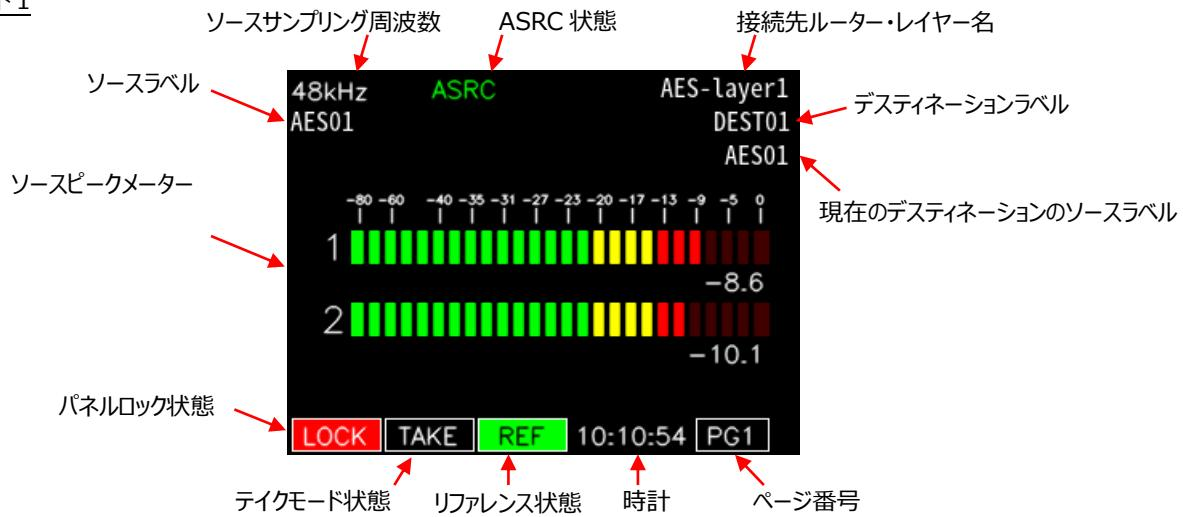
表示モード1は、上図に示した「ソースラベル」、「ソースピークメーター」、「ソースサンプリング周波数」、「ASRC状態」、「デスティネーションラベル」、「現在のデスティネーションのソースラベル」「接続先ルーター・レイヤー名」が表示されるモードです。「パネルロック状態」、「テイクモード状態」、「リファレンス状態」、「時計」、「ページ番号」はビデオ系ルーター接続時と同じなので、ここでの説明は省略します。
