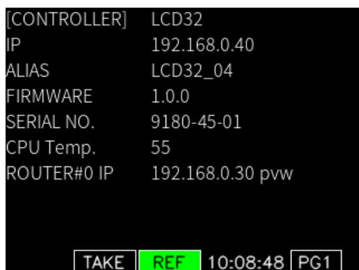
LCD16/32 の IP アドレスとプログラムバージョン情報、接続ルーターの IP アドレスを表示するモードです。
