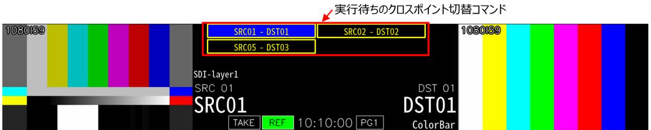
表示モード 2 では表示モード 1 のアナログ時計の代わりに実行待ちのクロスポイント切替コマンドが表示されます。クロスポイント切替コマンドの表示形式は「ソースラベル - デスティネーションラベル」です。実行待ちのクロスポイント切替コマンドが表示されるのはテイクモードがオンのときのみとなります。
