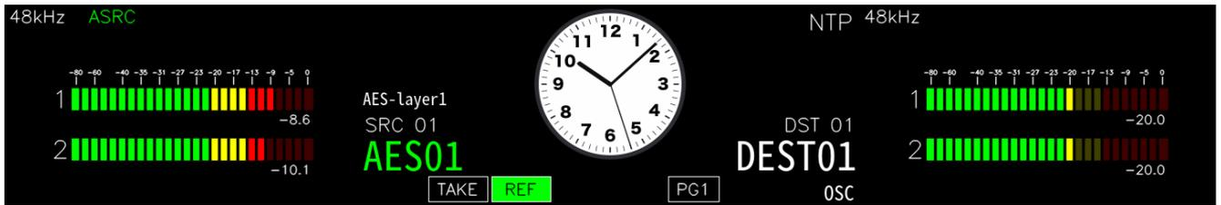
表示モード 1 では、ソースピークメーター・デスティネーションピークメーター・アナログ時計が同時に表示されます。
