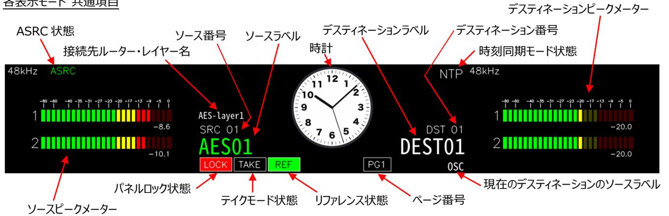
すべての表示モードまたは複数の表示モードで、上図に示した「ソース番号」、「ソースラベル」、「ソースピークメーター」、「ASRC 状態」、「デスティネーション番号」、「デスティネーションラベル」、「デスティネーションピークメーター」、「接続先ルーター・レイヤー名」、「時計」、「時刻同期モード状態」、「パネルロック状態」、「テイクモード状態」、「リファレンス状態」、「ページ番号」、「現在のデスティネーションのソースラベル」が表示されます。
