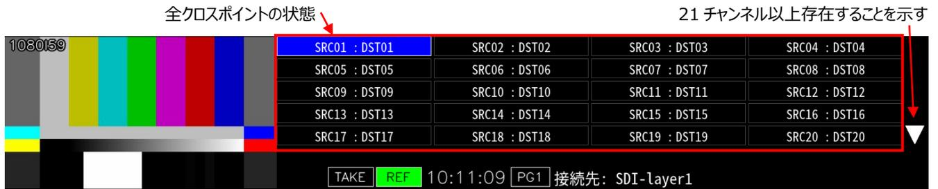
表示モード 3 では、全てのクロスポイントの状態が「ソースラベル : デスティネーションラベル」の形式で表示されます。現在選択されているデスティネーションが青表示となります。
