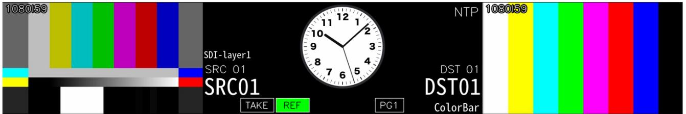
表示モード 1 では、ソース映像・デスティネーション映像・アナログ時計が同時に表示されます。
