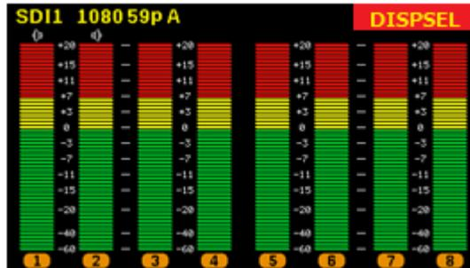
LCD 表示機能選択状態(DISPSEL ハイライト状態)で、再度 ENT スwitchを押すか、MENU,チャンネル選択スswitchを押すと LCD 表示機能選択状態が解除され、通常モードに戻ります。LCD 表示機能選択状態では、上下スswitch(4)で表示機能をダイレクトに切り替えることができます。▽スswitchを押すごとに以下の順番で表示機能が切り替わります。
