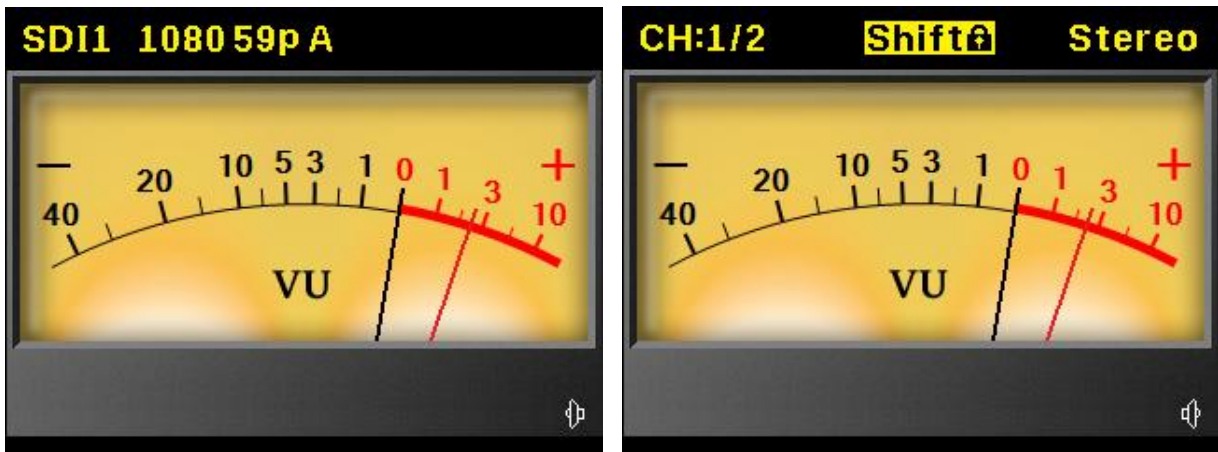
SDI1(1080p59 level A)、モニタチャンネル:1/2、シフトロック状態、ステレオ出力、Peak Hold Marker 有り
