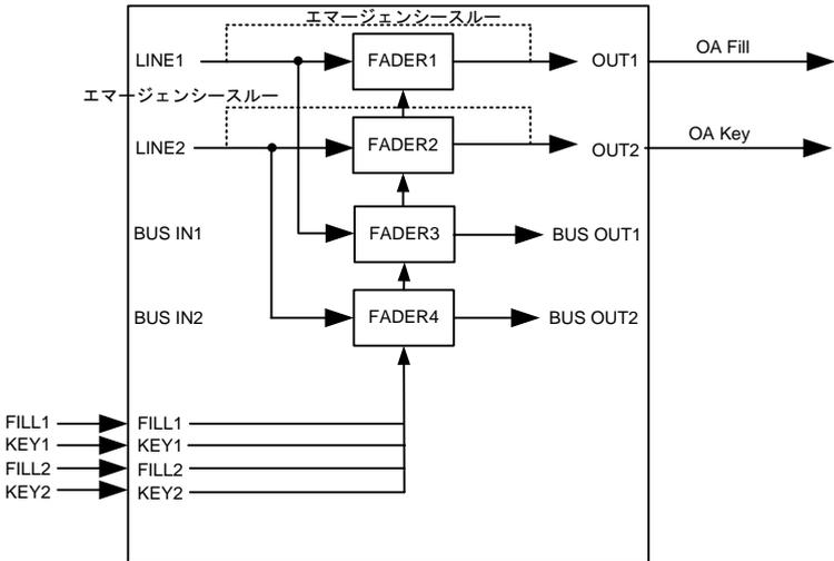
MANUAL に設定すると、各フェーダーへの入力信号の選択、スーパーの順序、各出力信号のどのフェーダーの出力を割り当てるかなど、マニュアル設定することができます。DSK1L 等で自動設定した後に、各種フェーダー設定等を変更すると、自動的に MANUAL モードとなります。通常は、DSK1L/DSK2L/COMB モードでお使いください。
