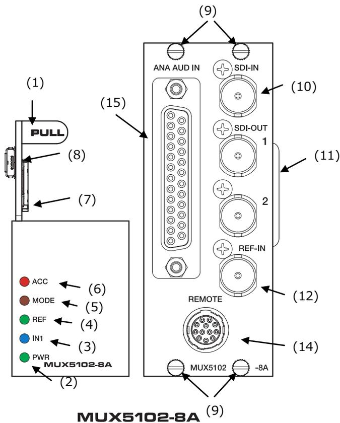
(1)フロントモジュール引き出し取っ手 (MUX5102-4D/8D/8A 共通)
