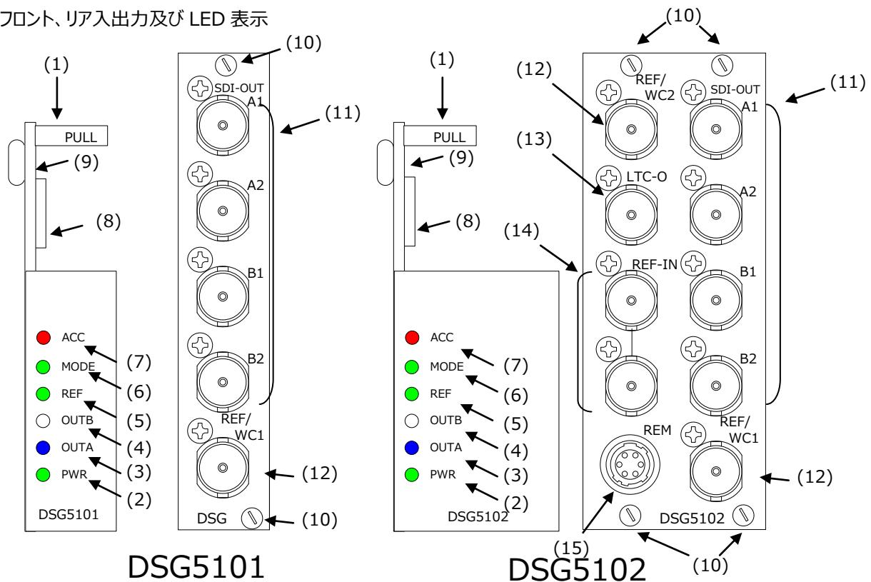
(1)フロントモジュール引き出し取手 (DSG5101, DSG5102 共通)
