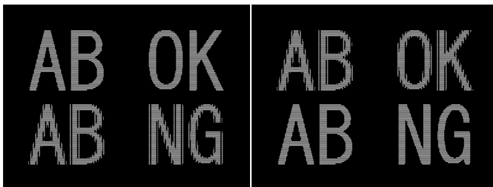
AB : 正しい配線をしたとき(左)・配線が逆のとき(右)
