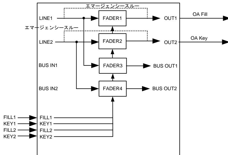
MANUAL に設定すると、各フェーダーへの入力信号の選択、スーパーの順序、各出力信号のどのフェーダーの出力を割り当てるかなど、マニュアル設定することができます。マニュアル設定は、8 – 3 – 3 . 入出力設定 @ MANUAL モードで別途設定してください。DSK1L 等で自動設定した後に、各種フェーダー設定等を変更すると、自動的に MANUAL モードとなります。通常は、DSK1L/DSK2L/COMB モードでお使いください。
