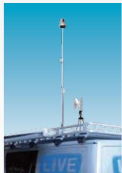
地上高5m簡易ポールリモコンカメラやIP伝送のアンテナが取付けられます。
