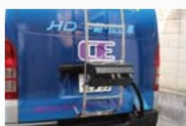
リアラダーに取付けたカメラコネクタ中継ボックス（オプション）
