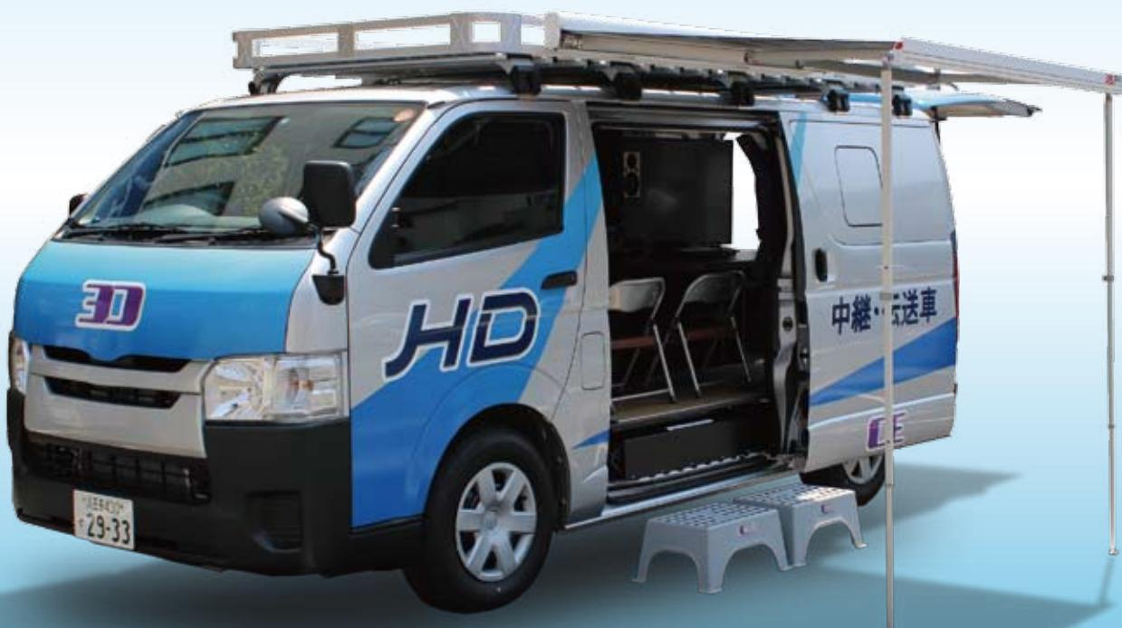
大容量発電システムを標準装備し、最大6台のカメラ搭載可能な小型中継・伝送車です。可変レイアウトの独創的な方法（特許第5898151号）により、定員乗車（5～6名）での移動と、4～5名での中継オペレートが可能な広大な車内空間を実現しました。車両は特別な改造をしておりませんので、（4又は5ナンバー）車検、定期点検整備、保険等が一般の車両と同じ扱いです。また、中継業務に使用しない時には、機材を降ろせば通常の貨物車として使用できます。
