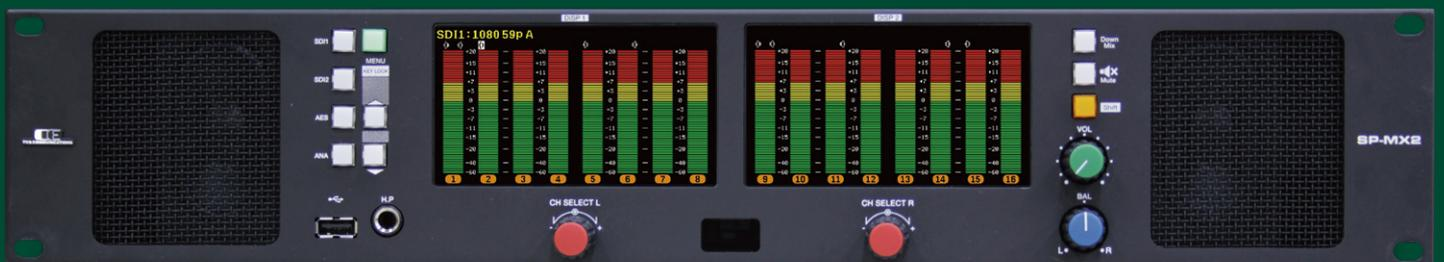
左チャンネル, 右チャンネル それぞれ独立して **16チャンネルオーディオのミキシング**ができる **エンベデッドオーディオモニタ**です。各チャンネルのミキシングや、レベルコントロール、左右への振り分けを自在に行うことができます。LAN, USB インターフェースを装備し、様々な機能拡張が可能です。
