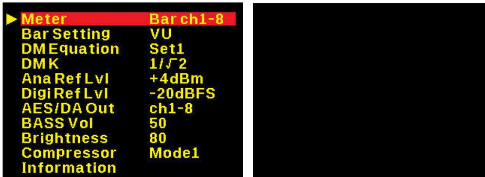
メニユー選択スイッチ(上下キー)③で設定を変更したい項目にカーソルを合わせてメニユースイッチ②を押すと選択した項目の設定値一覧がDISP2④に表示されます。現在の設定値がハイライト表示されます。
