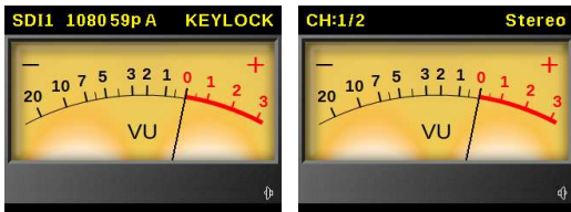
SDI1(1080p59 LevelA) / キーロック中 / モニタチャンネル: 1, 2 / ステレオ出力
