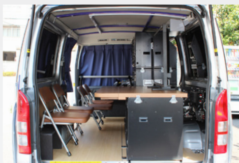
機器ラックを移動してテーブルをセット
