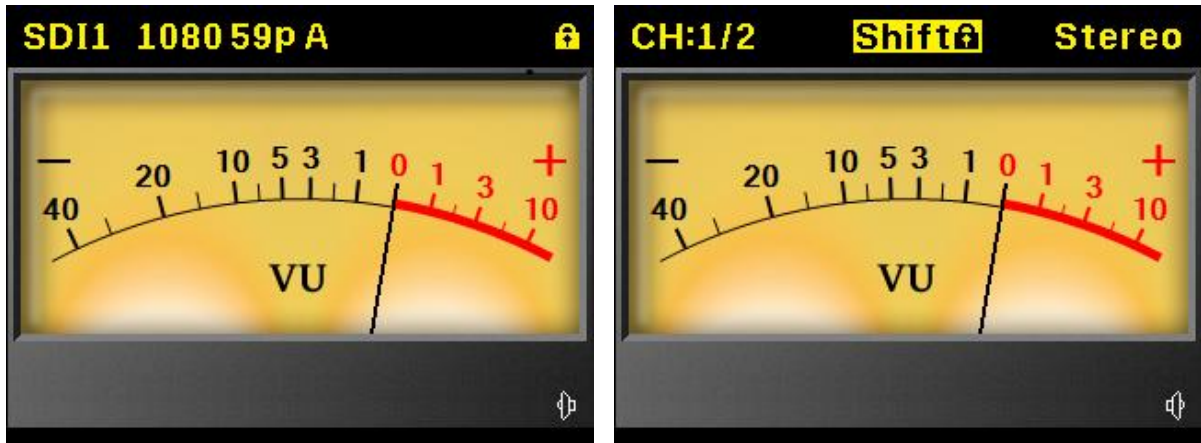
SDI1(1080p60 level A)、キーロック状態、モニタチャンネル:1/2、シフトロック状態、ステレオ出力
