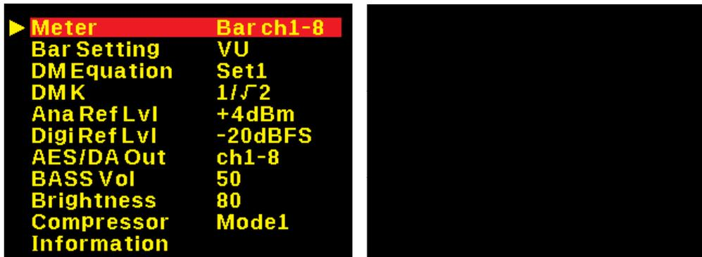
メニュー選択スイッチ(上下キー)③で設定を変更したい項目にカーソルを合わせてメニュースイッチ②を押すと選択した項目の設定値一覧がDISP2④に表示されます。現在の設定値がハイライト表示されます。
