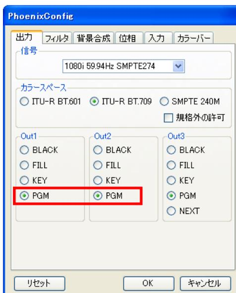
図 6.7 P1000 で内部合成を使用する場合の設定
