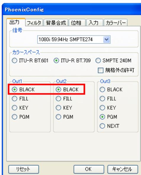
図 6.8 P1000 で内部合成を使用しない場合の設定
