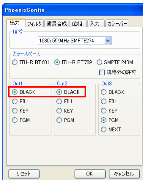
図 5.9 P1000 で内部合成を使用しない場合の設定
